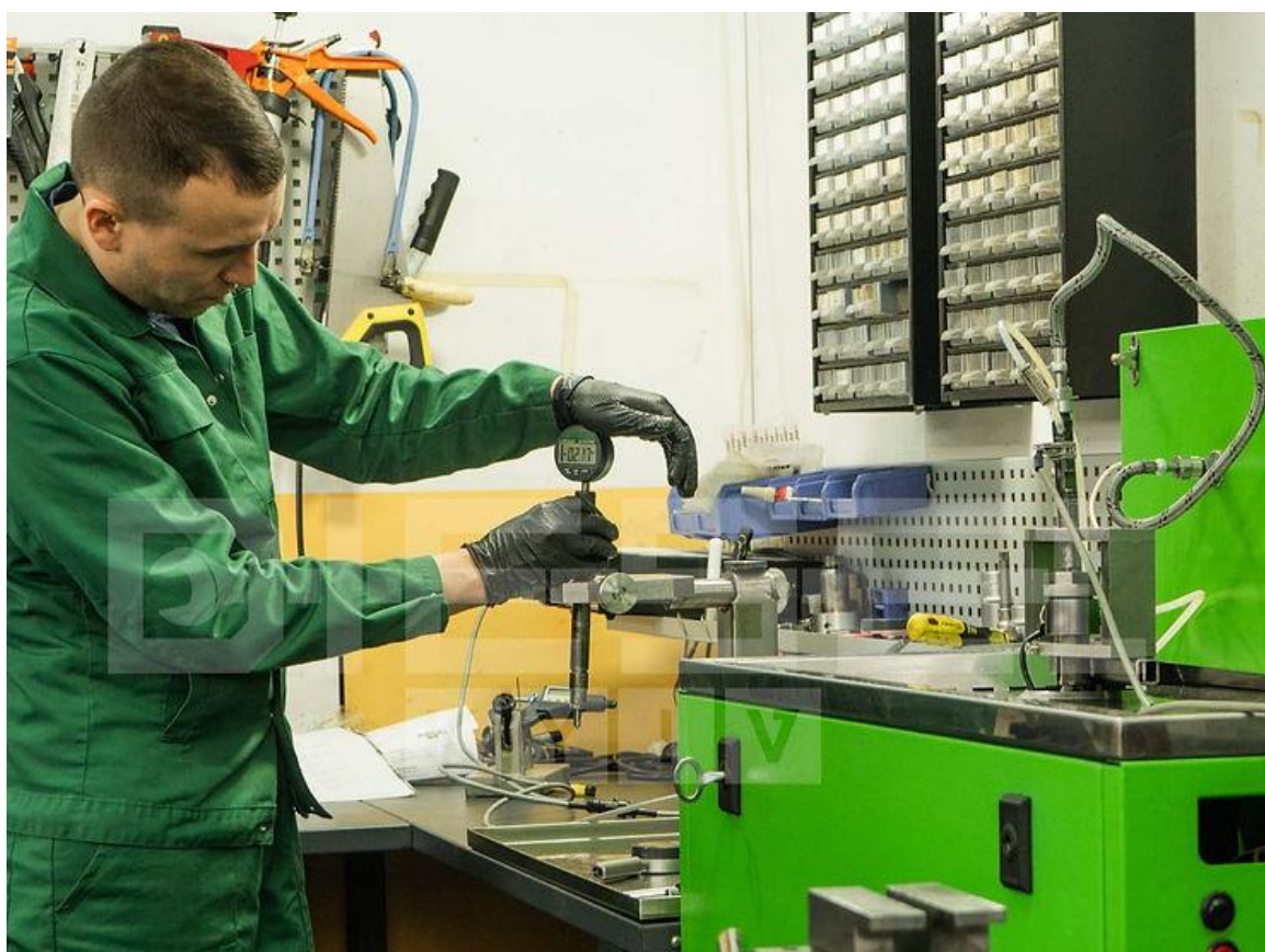
Рис.3.9. Діагностика форсунки у спеціалізованому сервісному центрі [10]
