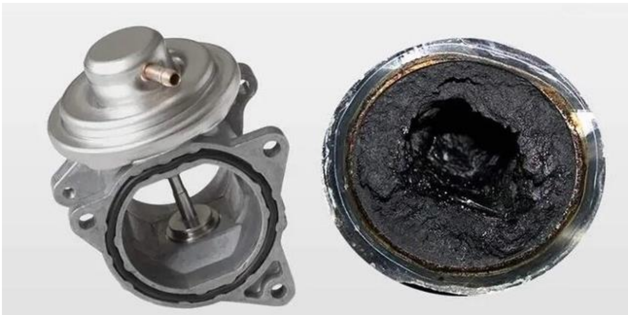
Рис. 2.1 - Ліворуч – новий клапан EGR, праворуч – клапан EGR при пробігові орієнтовно 150 000 км [11]
