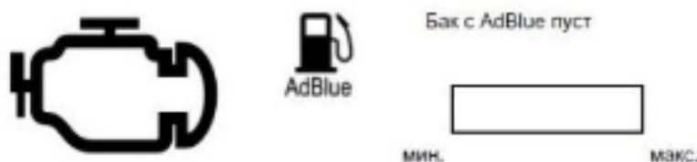
Рис. 2.4 – Сигнальна лампа на панелі приладів [7]
