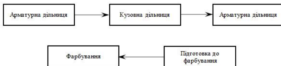
Рис. 2.1. Схема переміщення автомобіля під час виконання кузовного ремонту
