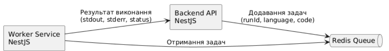
Рис. 2.18. Схема роботи черги повідомлень
