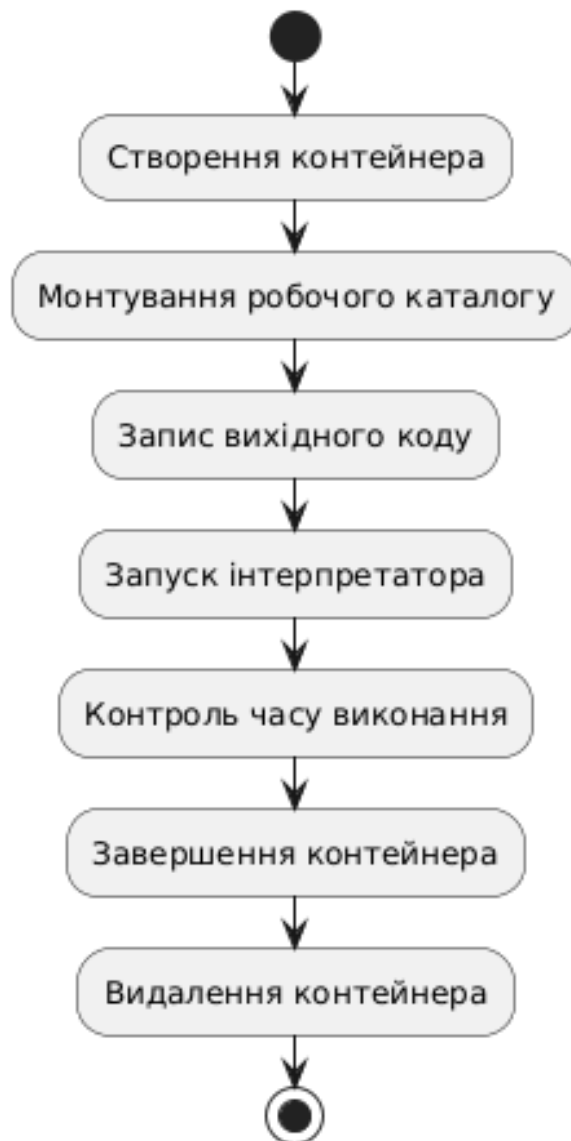
Рис. 2.10. Алгоритм виконання програмного коду в Docker-контейнері
