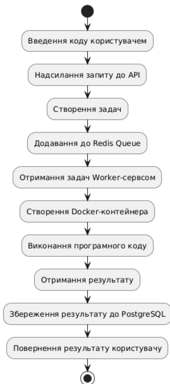
Рис. 2.7. Загальний алгоритм роботи системи
