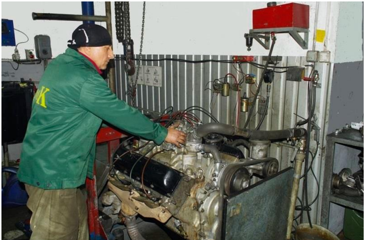
Рис. 2.3 Обкатування двигуна внутрішнього згорання
