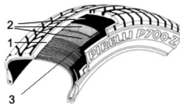
Рис. 2.4. Будова радіальної шини з металокордом: 1 – протектор; 2 – брекер з декількох шарів нейлонової тканини (зверху) і металокорду (знизу); 3 – радіальні нитки металокордного каркасу
