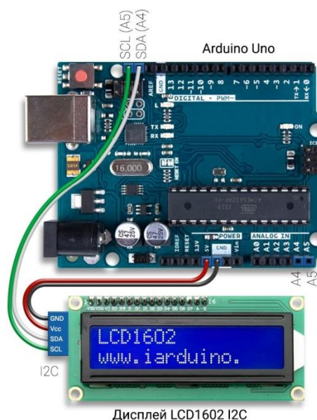
Рис. 3.17. Підключення LED 1602 I2C до Arduino
