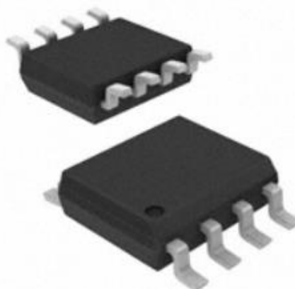
Рис. 3.9. – RTC DS1338Z-33 годинник точного часу.
