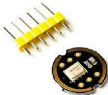
Рис. 3.5. - Зовнішній вигляд всепрямованого електронного мікрофона INMP441
