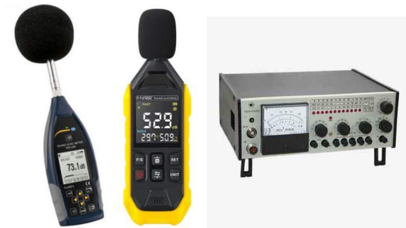
Рис. 2.5. Шумоміри: 1 - PCE-430, 2 - FNIRSI FDM01, 3 - ВШВ-003-M2
