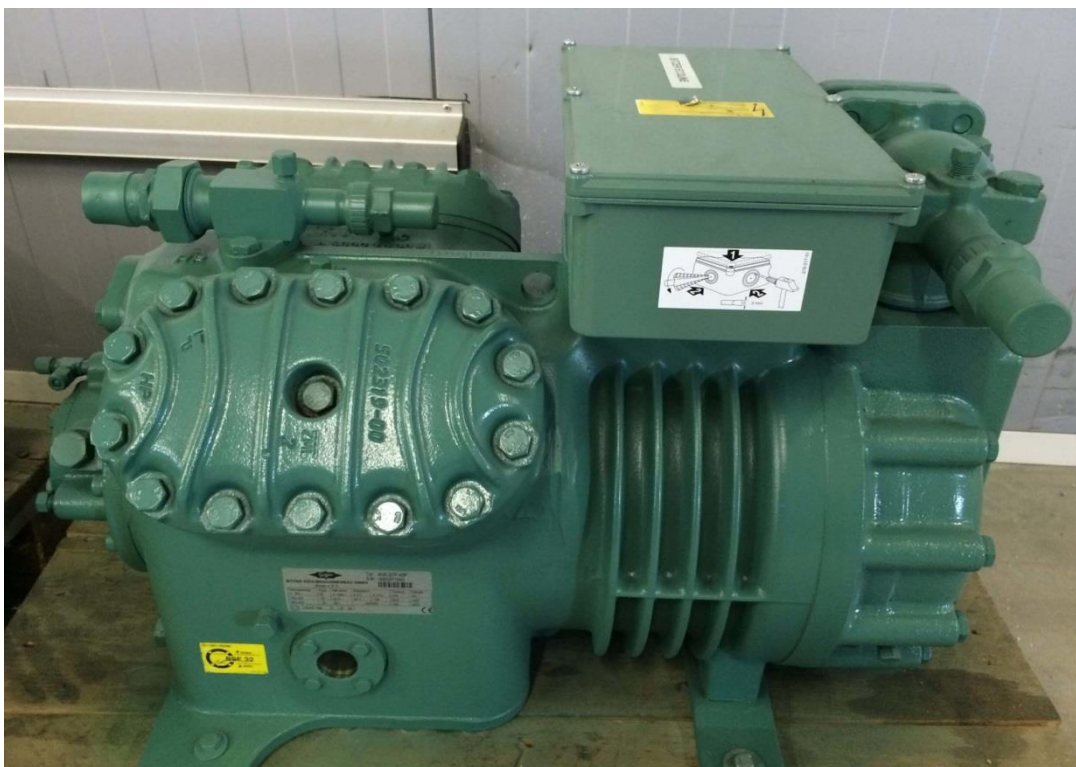
Рис. 1.1. компресор холодильного агрегату
