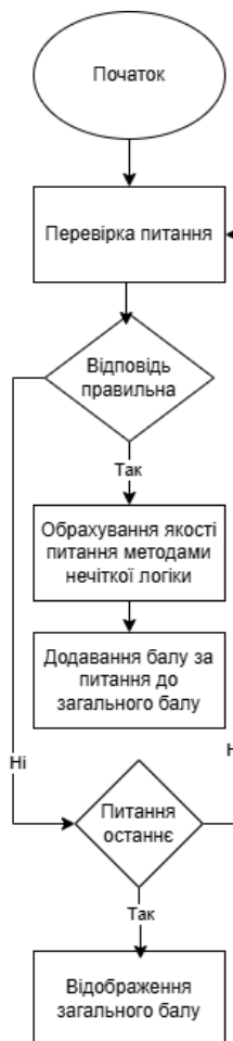
Рис. 2.8. Блок-схема процесу обрахунку оцінки
