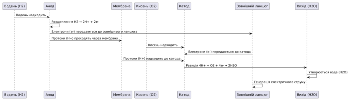
Рис 2.1. Принцип роботи паливної комірки (PEMFC)
