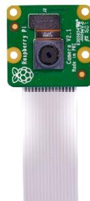
Рис. 3.3. Камера Raspberry Pi Camera Module V2
