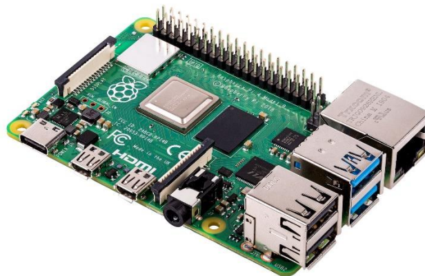
Рис. 3.4. Одноплатний комп'ютер Raspberry Pi 4
