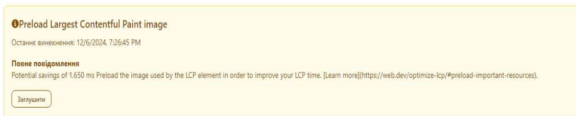
Рисунок 3.31 – Рекомендація отримана від сервісу веб-аналітики щодо попереднього завантаження найбільшого контенту
