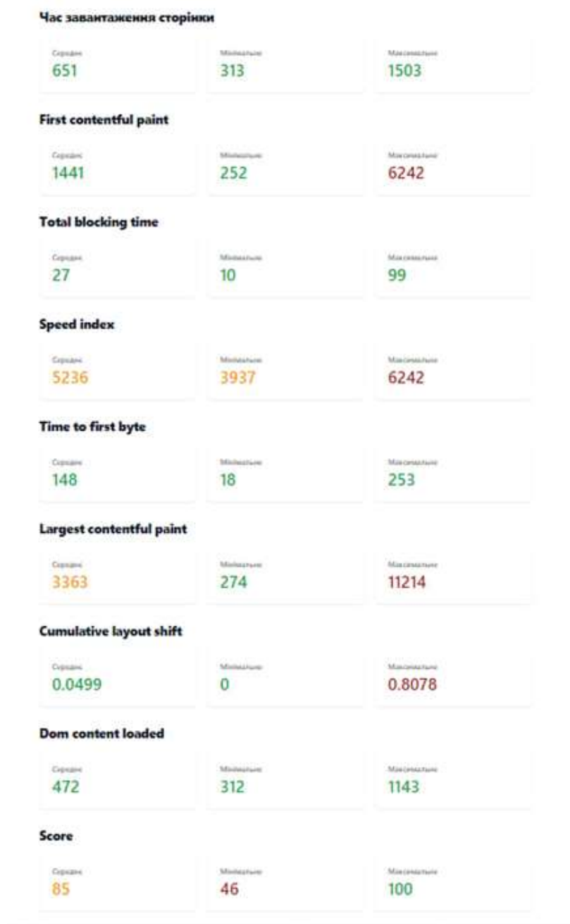
Рисунок А.1 – Результати вимірювання продуктивності після першого етапу оптимізації
