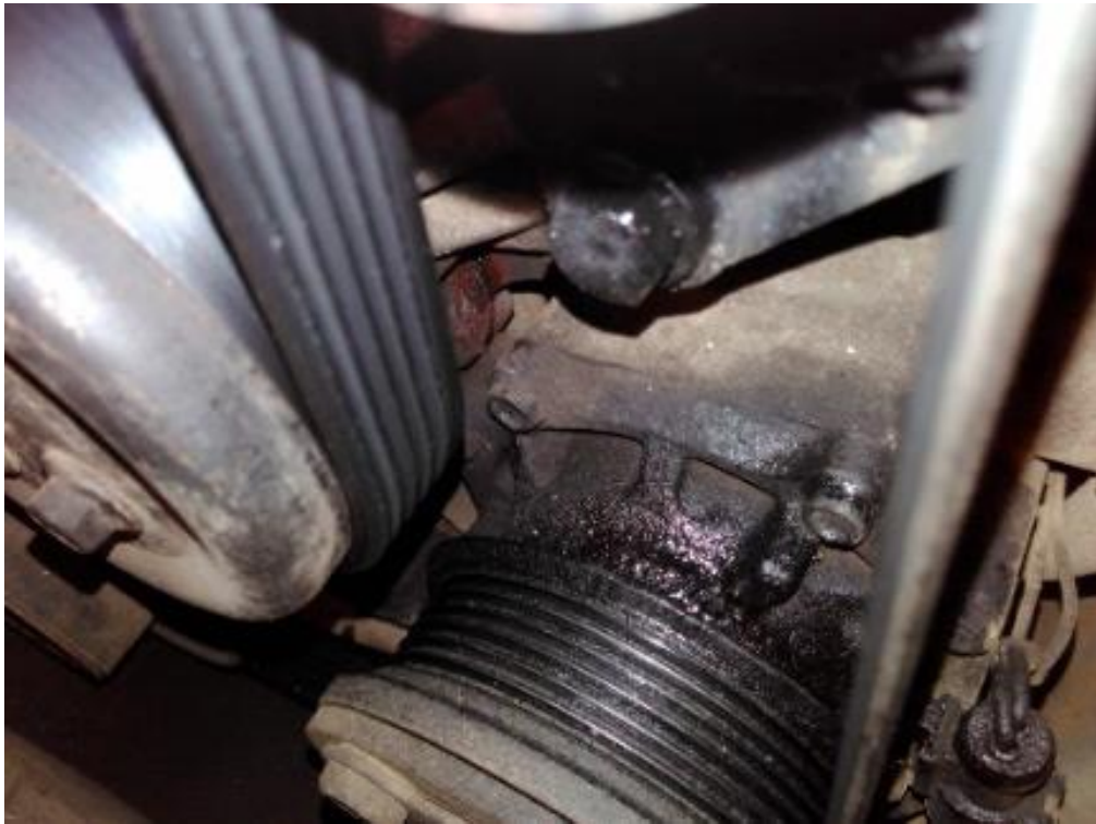
Рис.1.11. Підтікання водяної помпи [8]
