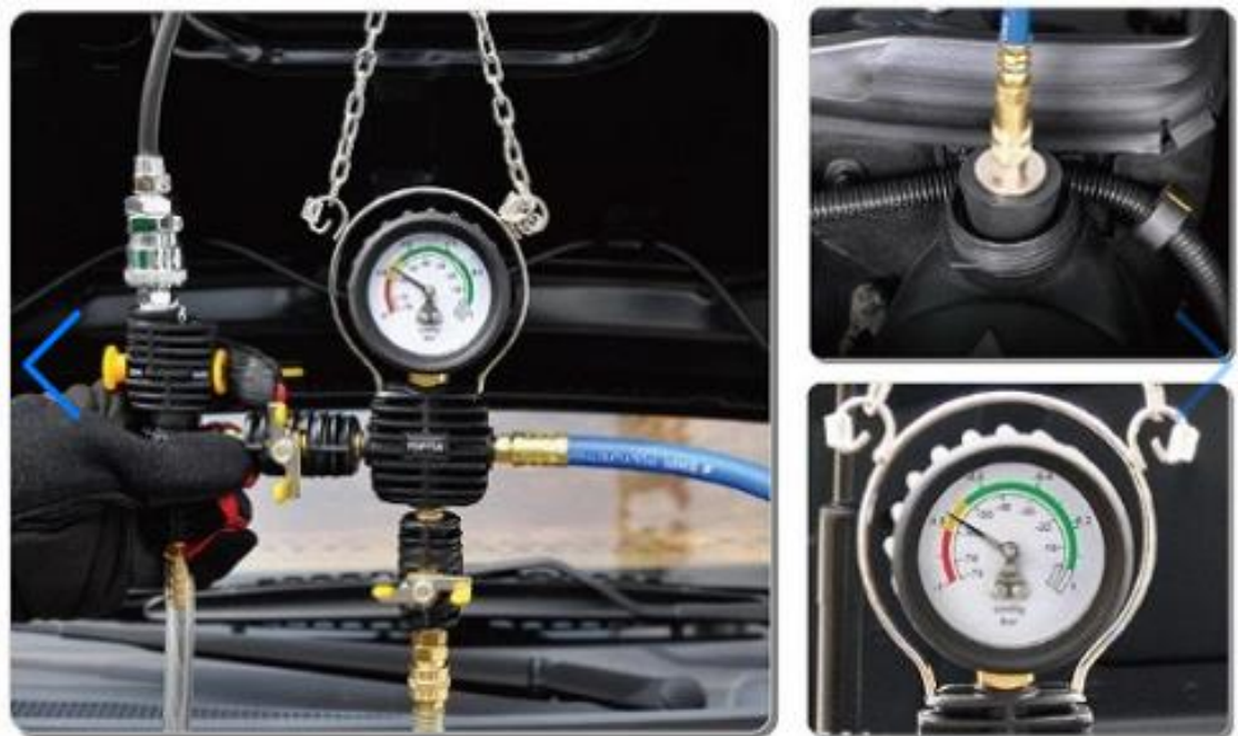
Рис.2.2. Пристрій для перевірки герметичності системи охолодження та працездатності пароповітряного клапана
