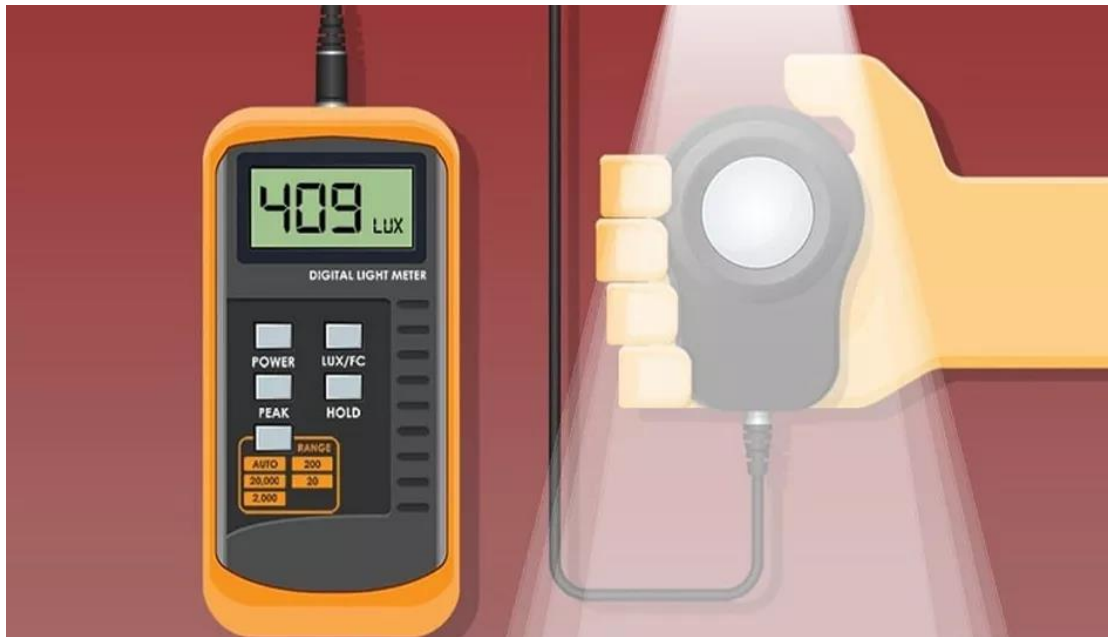
Рис.1.5. Принцип роботи люксметра
