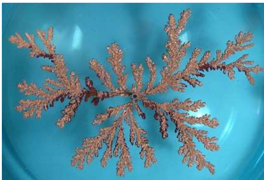
Рис. 1.2. Кластер DLA, вирощений із розчину мідного купоросу в комірці електроосадження
