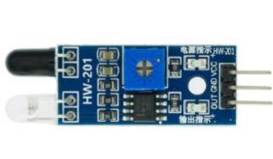
Рис.3.4. Інфрачервоний датчик перешкод
