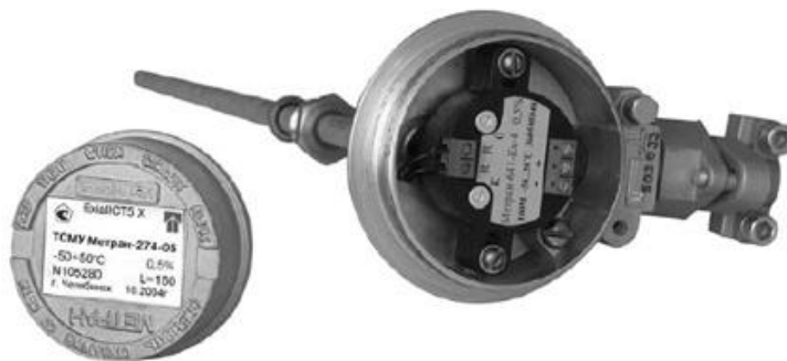
Рис. 2.19 Термодатчик ТСПУ Метран - 276
