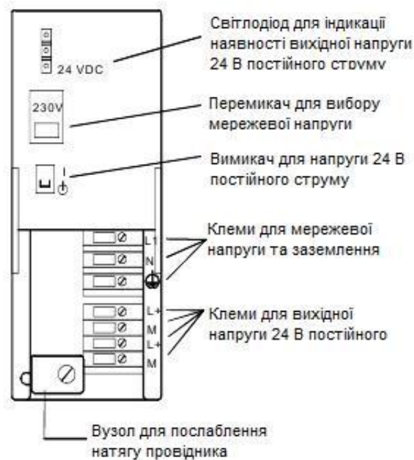
Рис. 3.10. Схема підключення блоку живлення
