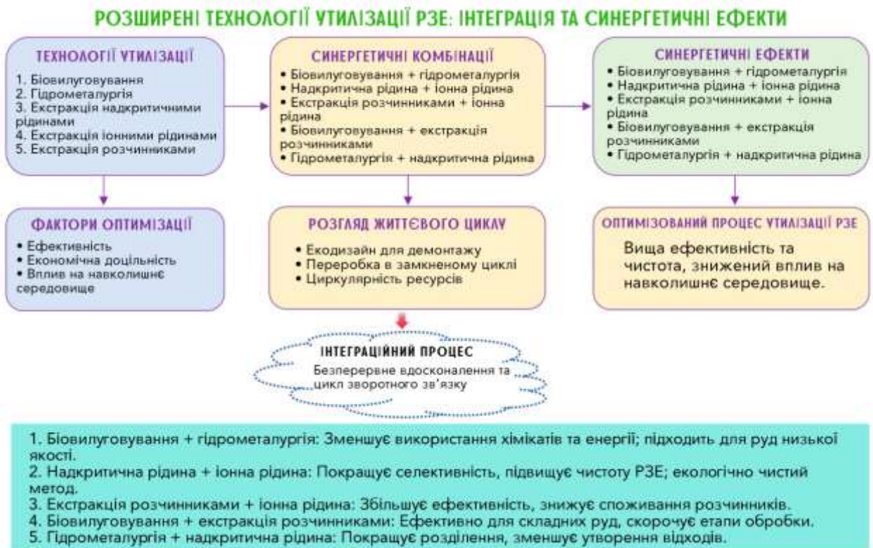
Рис. 3.2 Принципова схема оптимізації та інтеграції технології відновлення РЗЕ.
