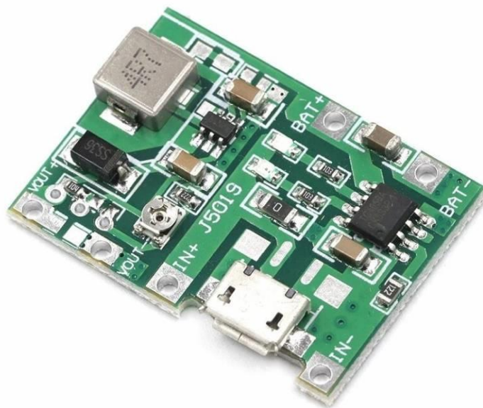
Рис.4.12 Модуль заряду Li-Ion АКБ з DC/DC step-up перетворювачем J5019
