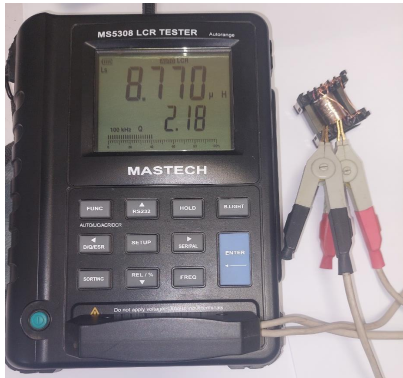
Рис 3.4.2 Замір індуктивності трансформатора ББЖ1
