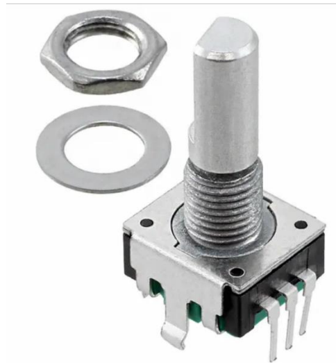
Рис.3.3 Енкодер Bourns PEC11
