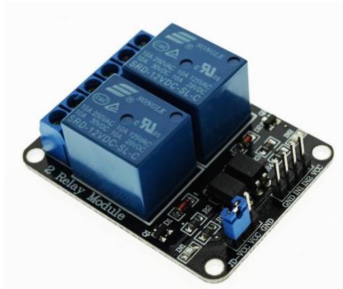
Рис.3.5. Модуль реле RelayModule-5V-2
