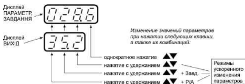
Рис. 4.5. Схема позначень дисплея
