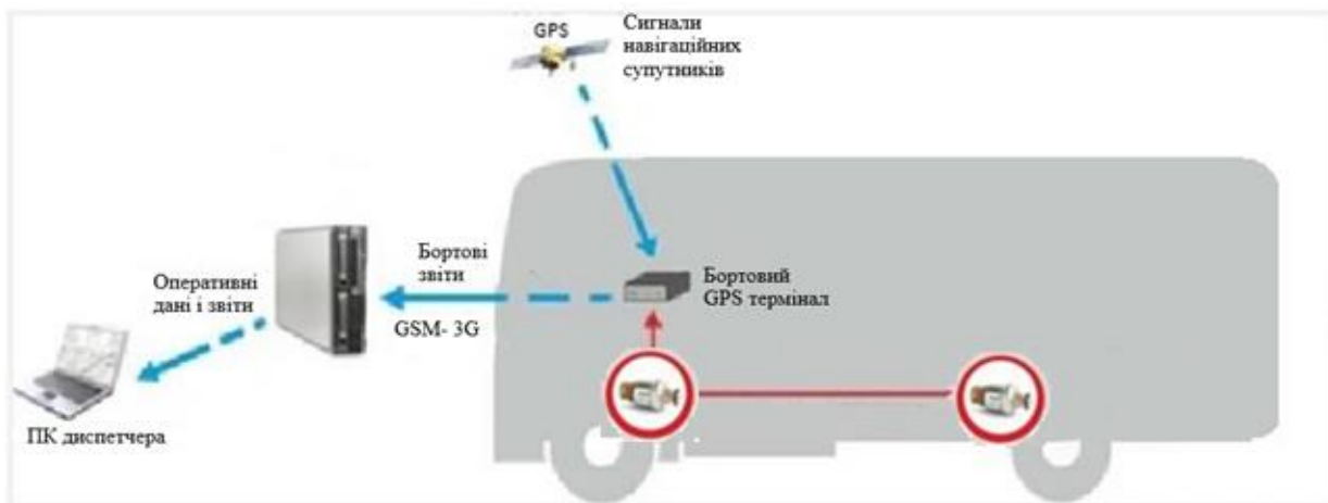
Рис. 3.1. Схема роботи обладнання у системах GPS-моніторингу з використанням датчиків навантаження на вісь
