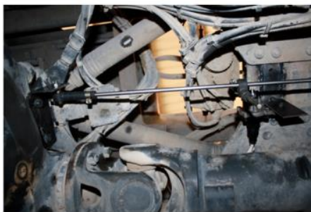
Рис. 3.2. Варіанти розміщення датчиків на підвісці автобусів.
