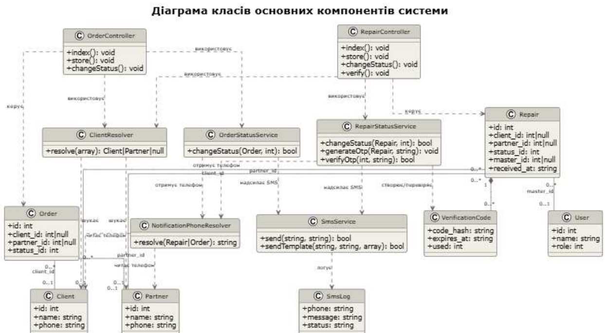
Рисунок 2.6 - Діаграма класів системи (UML Class Diagram)
