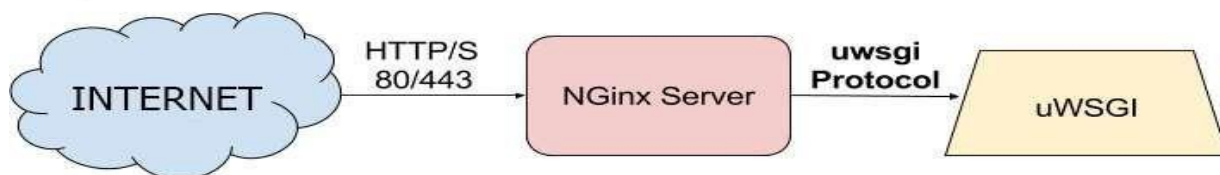
Рисунок 3.9 - Принципова схема взаємодії NGINX і uWSGI
