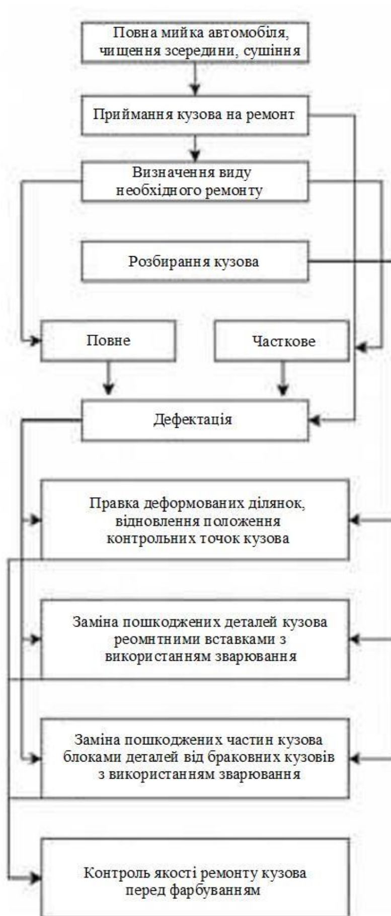
Рис. 1.6 - Схема технологічного процесу кузовного ремонту
