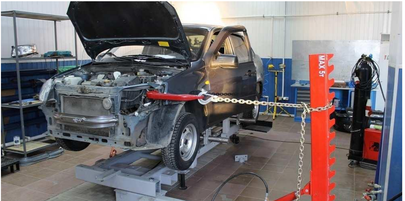
Рис. 1.4 - Процес відновлення геометрії кузова на стапелі
