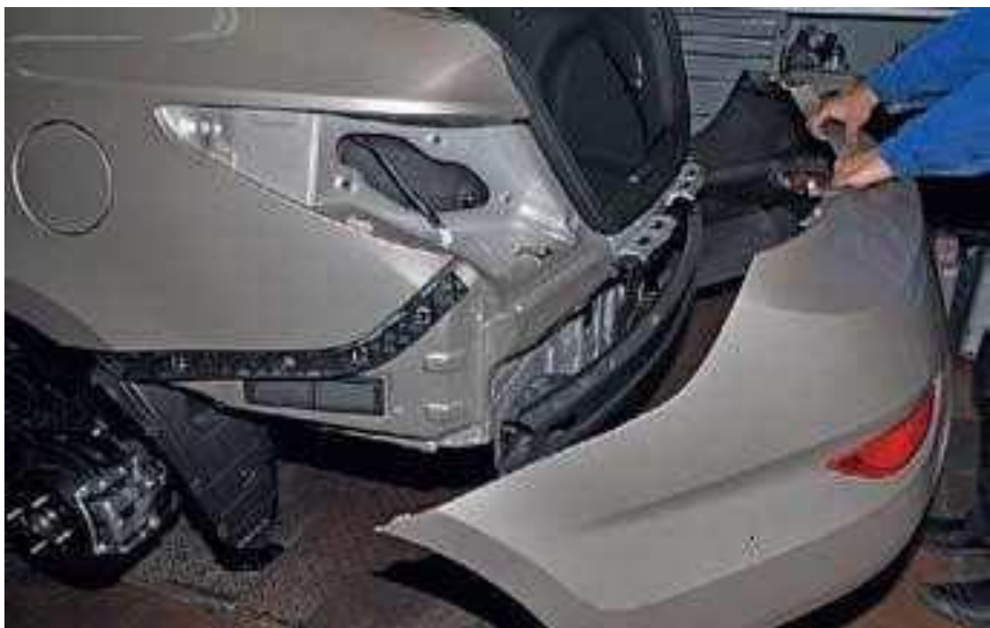
Рис. 3 - Процес зняття бампера автомобіля
