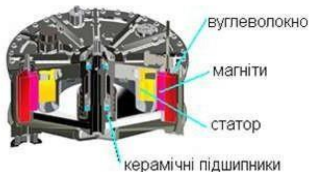
Рис. 2.5 – Електромеханічний маховик автомобіля Porsche GT3 R Hybrid
