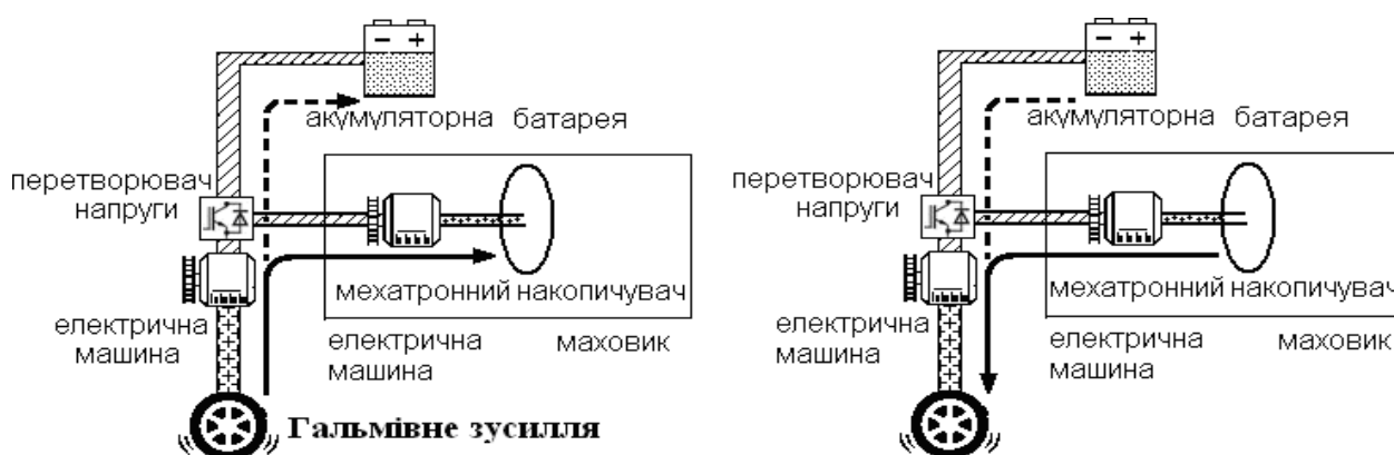
Рис. 2.6 – Принцип роботи мехатронного накопичувача енергії
