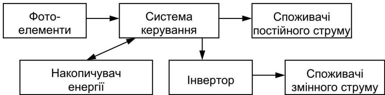
Рис. 3.2 – Схема структурна системи електроживлення на фотоелементах
