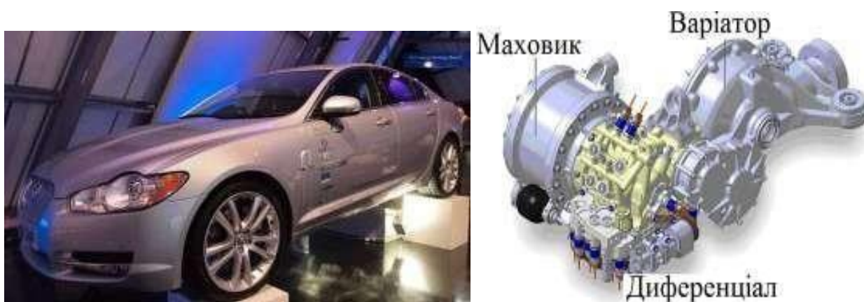
Рис. 2.3 – Прототип Jaguar XF з маховичним накопичувачем енергії
