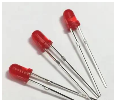
Рис.3.14.Червоний світлодіод моделі L-1154GT від компанії Kingbright
