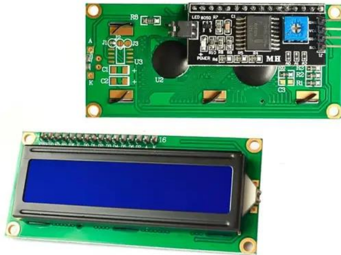
Рис. 3.12. Дисплей LCD 1602 з I2C
