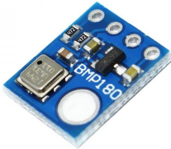
Рисунок 3.10. Барометричний датчик BMP180
