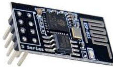
Рисунок 3.7. Wi-fi модуль ESP-01
