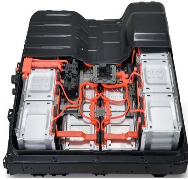
Рисунок 1.3. – Батарея Nissan Leaf другого покоління без використання рідинного охолодження
