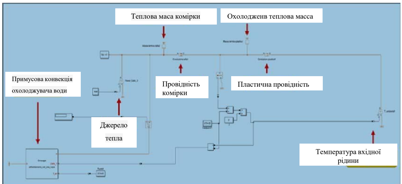
Рисунок 3.14 – Модель із зосередженими параметрами системи охолодження акумуляторної батареї
