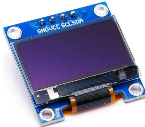
Рисунок 3.11 Дисплей OLED Adafruit SSD1306
