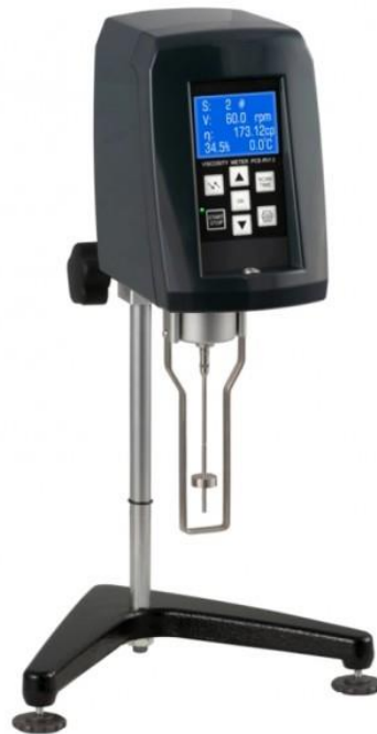
Рис.1.6. PCE-RVI 2 цифровий віскозиметр
