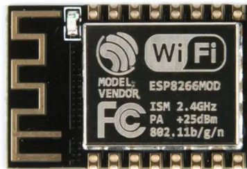
Рис.3.17. wi-fi модуль ESP-12S
