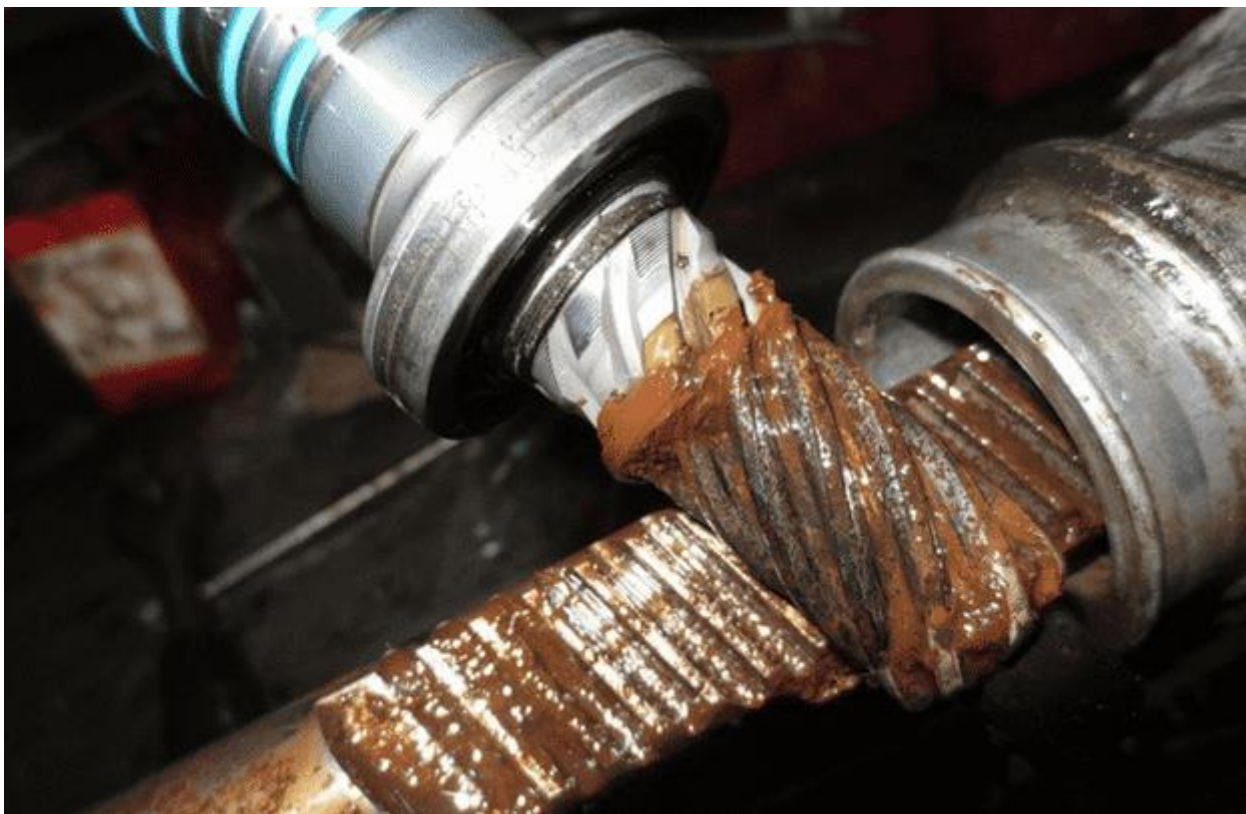
Рис. 1.6.. Зношування зубців рейки та шестерні [9]
