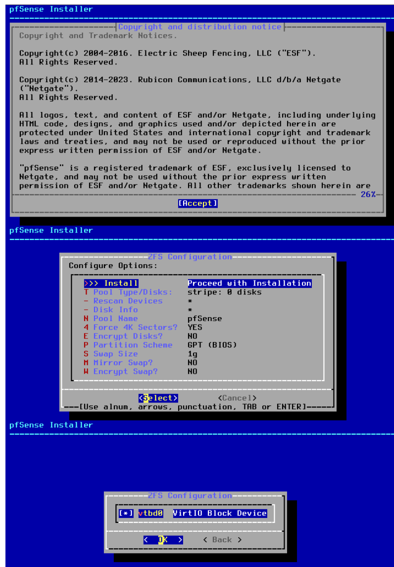
Рис. 3.17 Підготовка маршрутизатора, встановлення pfSense на маршрутизатор
