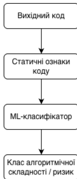
Рис. 1.6 – Схема прогнозування алгоритмічної складності та потенційних дефектів часу виконання на основі статичних ознак коду
