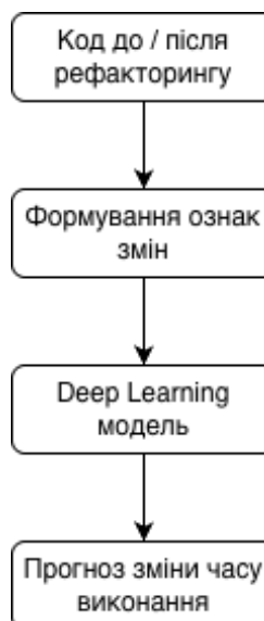
Рис. 1.9 – Схема прогнозування впливу рефакторингу на час виконання програми в підході MovePerf
