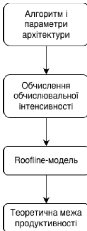
Рис. 1.3 – Узагальнена схема застосування Roofline-моделі для оцінювання теоретичної межі продуктивності алгоритму
