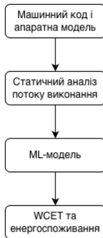
Рис. 1.4 – Схема статичного оцінювання найгіршого часу виконання та енергоспоживання програм у системі WORTEX
