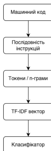
Рис. 1.2 – Схема перетворення машинного коду у векторне подання для задач машинного навчання
