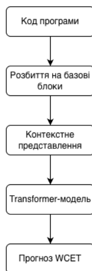
Рис. 1.5 – Узагальнена схема контекстно-орієнтованого оцінювання найгіршого часу виконання в підході CAWET
