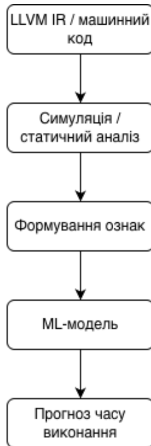
Рис. 1.11 – Узагальнена схема гібридного прогнозування часу виконання програм на основі аналізу LLVM та машинного навчання (PrETi)
