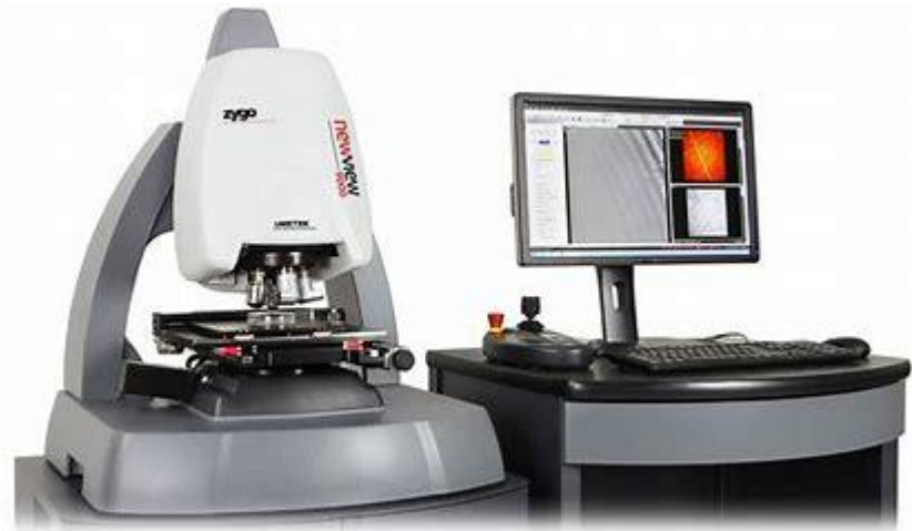
Рис 2.4 Зовнішній вигляд Zygo NewView Surface Profilometer [5]
