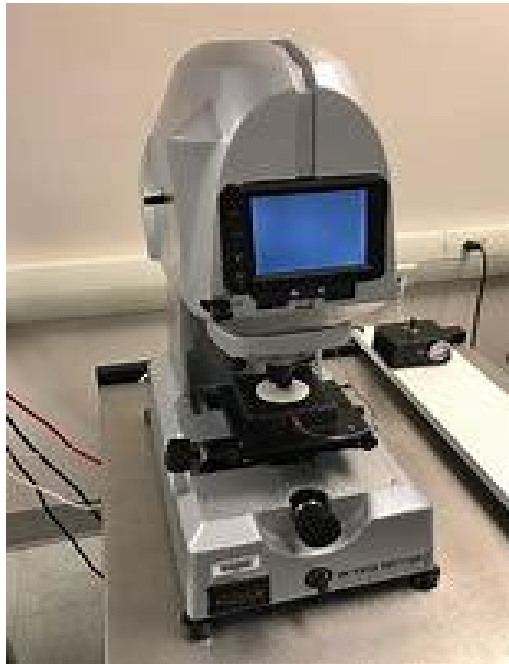
Рис 2.1 Зовнішній вигляд Wyko NT9100 Optical Profiler[2]
