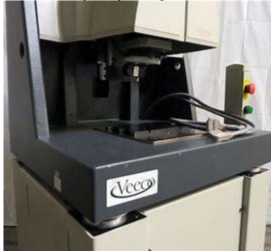
Рис 2.2 Зовнішній вигляд Veeco Wyko Profilometer[3]
