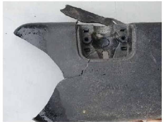
Рисунок 1.3 – Механічні дефекти пластмасових деталей: подряпини та потертості (а), тріщини (б), руйнування з втратою фрагмента (в) та повне руйнування деталі (г)
