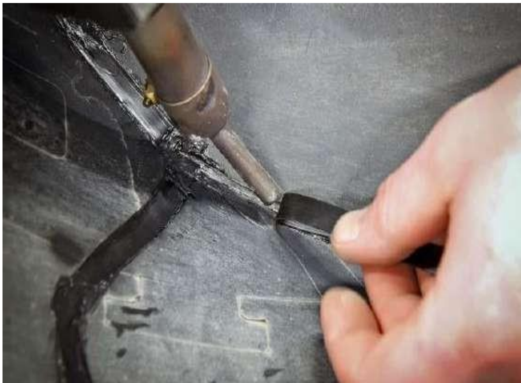
Рисунок 1.5 – Відновлення деталі зварюванням нагрітим газом
