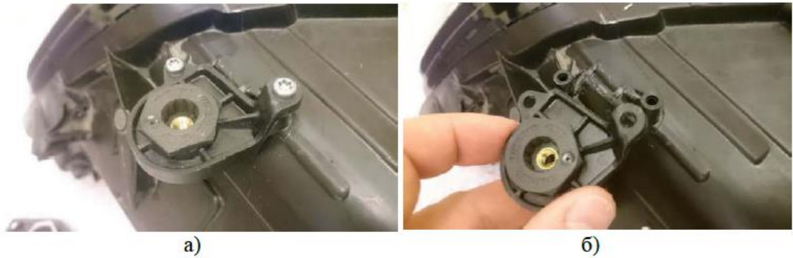
Рисунок 1.12 – Відновлення кронштейна фари (а) ремонтним комплектом (б)
