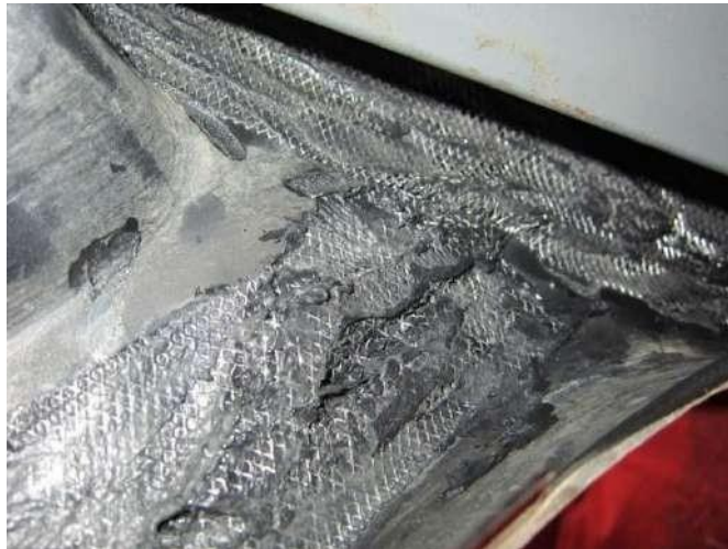
Рисунок 1.10 – Відновлення деталей з армуванням
