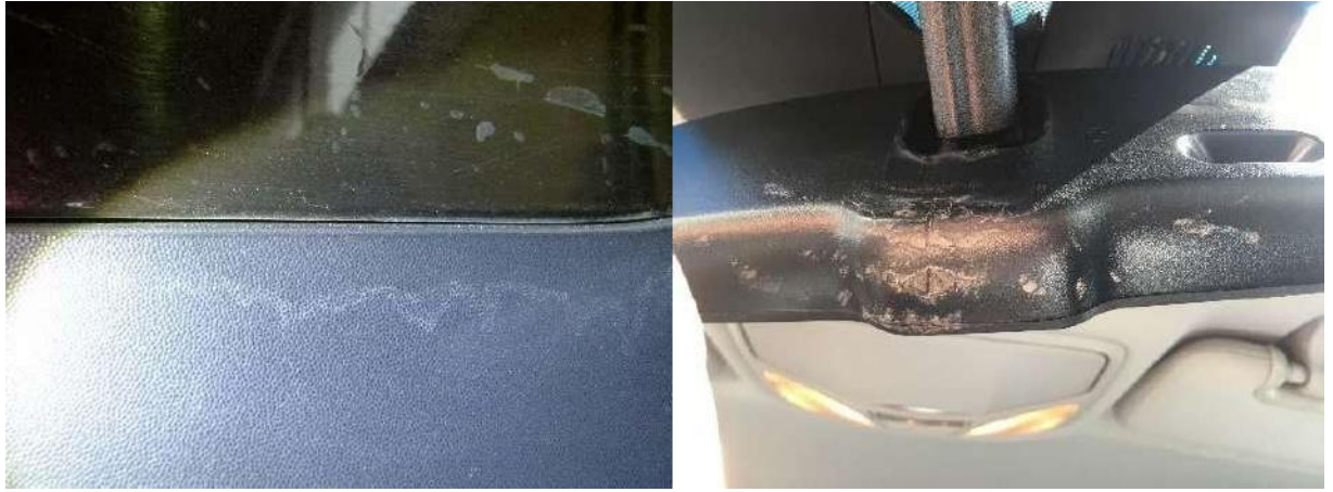
Рисунок 1.2 – Хімічне пошкодження пластмасових деталей: сліди від хімічної речовини (а) і розплавлення матеріалу (б), що не видаляються.
