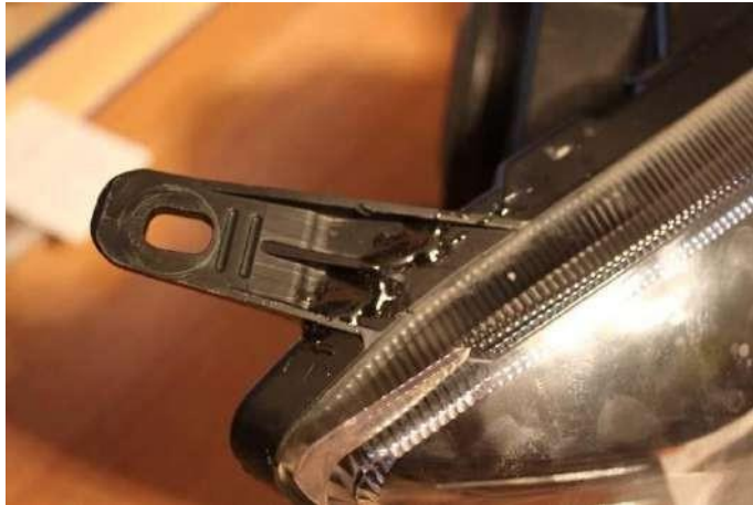
Рисунок 1.11 – Ремонт за допомогою клейової сполуки
