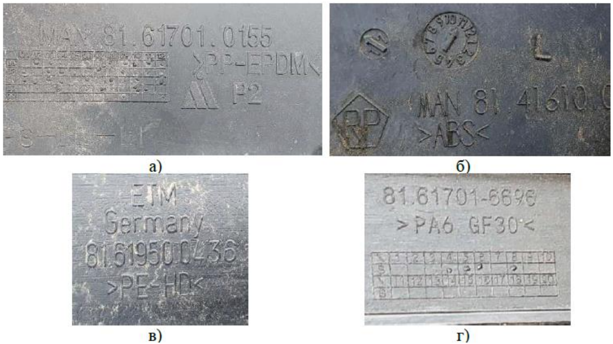
Рисунок 1.14 – Маркування деталей із різних пластмас: поліпропілен з додаванням етилен-пропіленового каучуку (PP+EPDM) (а); акрилонітрилбутадієнстирол (ABS) (б); поліетилен низького тиску (PE-HD) (в); поліамід 6 с додаванням 30% скловолокна (PA6 GF30) (г)
