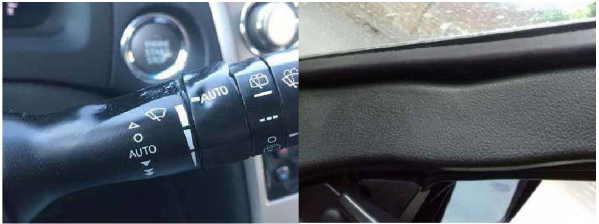
Рисунок 1.1 – Теплове оплавлення (а) та деформація (б) пластмасових деталей
