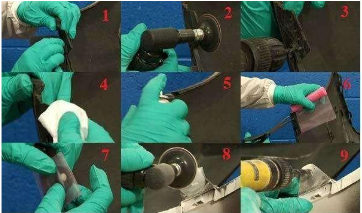
Рисунок 1.13 – Технологія відновлення пластмасових деталей складами 3М
