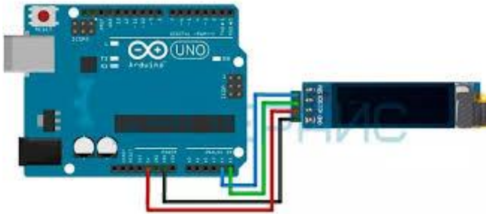
Рисунок 3.1.6 – Схема підключення дисплея
