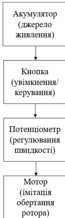
Рисунок 5.2.1 – Структурна схема макету лічильника
