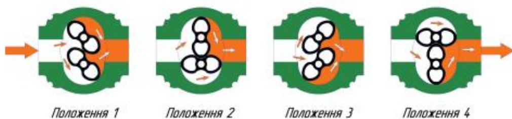
Рисунок 1.3.1 – Схематичне зображення принципу дії роторного лічильника газу
