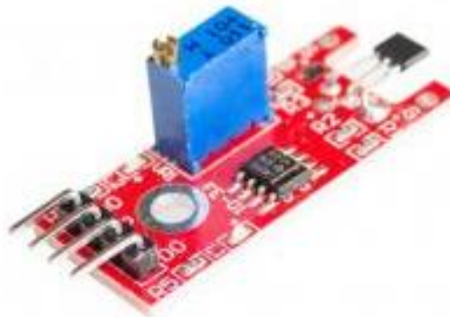
Рисунок 2.4.1 – Модуль датчика Холла SS49E
