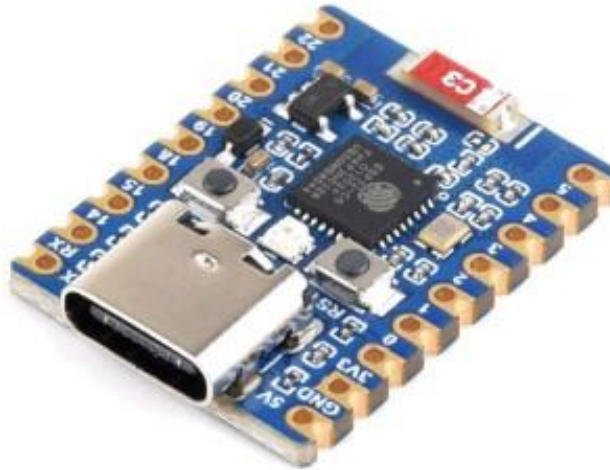
Рисунок 2.3.3 – Плата розробника ESP32-C6-Zero Mini (ESP32-C6FH4, WiFi 6, Bluetooth 5)
