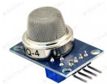
Рисунок 3.1.3 – Модуль датчика газу MQ-4
