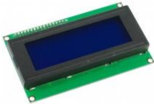
Рисунок 2.6.1 – LCD 2004 символний дисплей 20x4 (синій)
