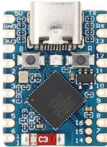
Рисунок 2.3.2 – Плата ESP32-S3-Zero Type-C 4MB
