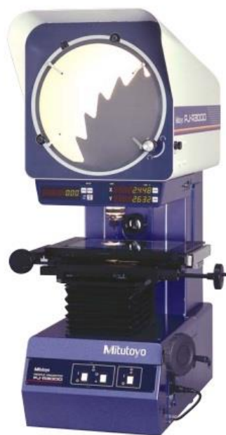
Рисунок 1.3 Вимірювальний проектор Mitutoyo PJ-A3005 F-150
