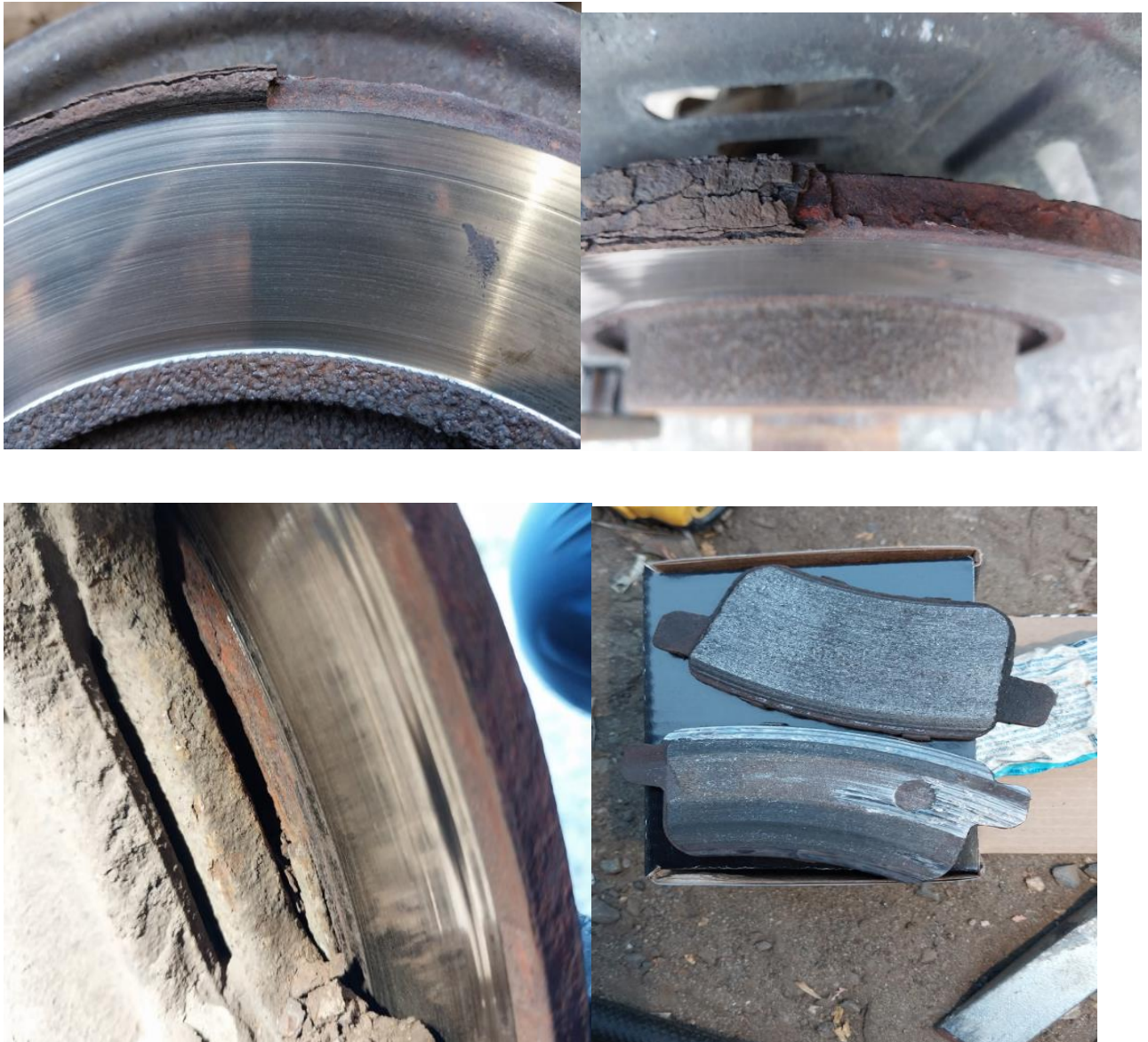
Рис 1.2.1 утворення бурту по краю, зниження рівномірності поверхні, зменшення товщини диска.
