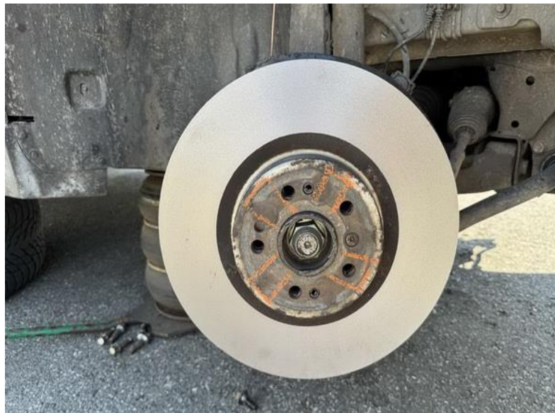
Рис. 3.2 Готовий результат після проточування .
