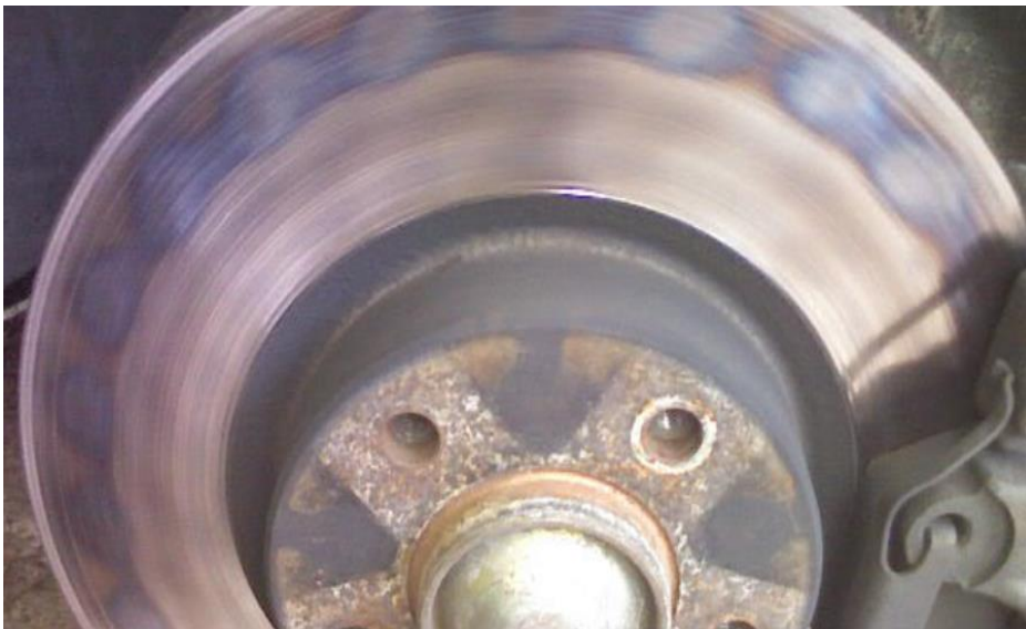
Рис.1.2.3 Перегрітий гальмівний диск Renault logan
