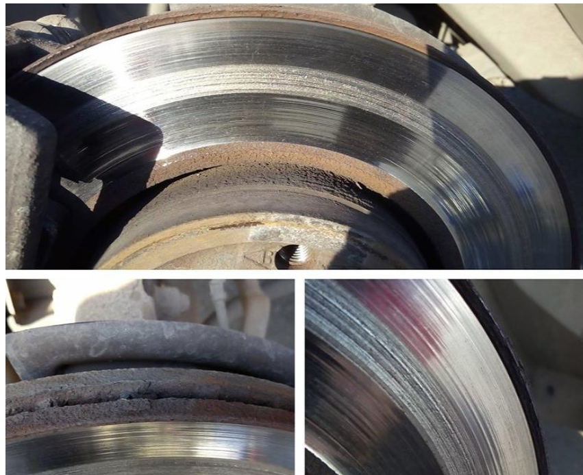
Рис. 1.2.2 Гальмівний диск Renault Clio заклинювання напрямних супорта; перекіс колодок; нерівномірний розподіл гальмівних зусиль.
