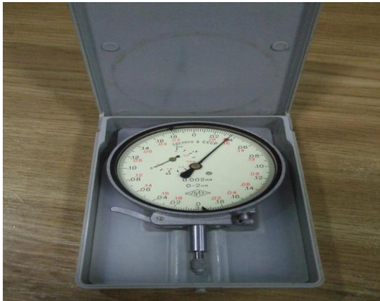
Рис. 4.1 Індикатор годинникового типу Рис. 4.2 Вмірювач шорсткості поверхні.
