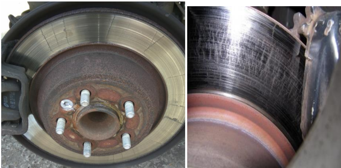
Рис.1.2.4 Диски з тріщинами Renault Sandero
