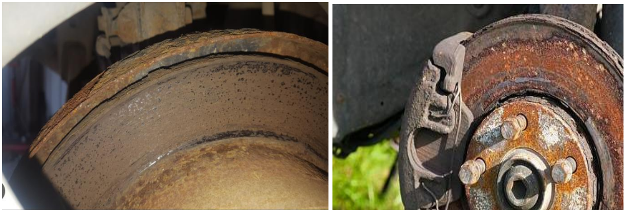
Рис.1.2.5 Іржа на робочій поверхні диска Renault Megane
