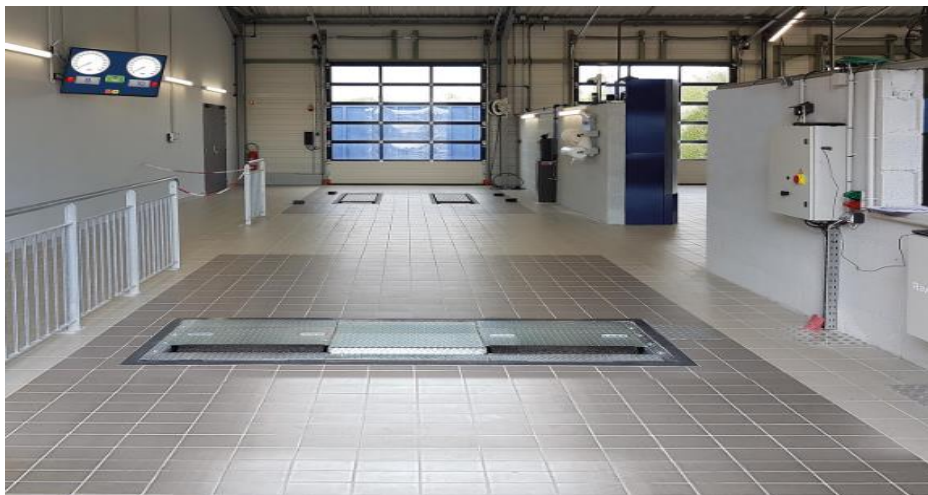
Рис 3.8.1 Гальмівний стенд роликового типу Ravaglioil RT 102 2.5
