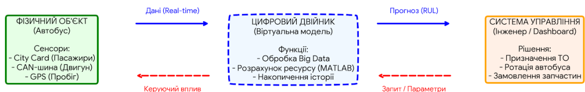
Рис. 2.5. Схема інформаційної взаємодії в контурі «Автобус — Цифровий двійник»
