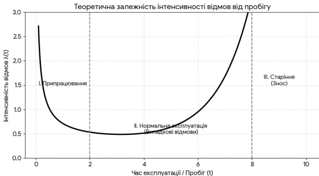
Рис. 2.1. Класична крива інтенсивності відмов («Ванна крива») для механічних систем автобуса.
