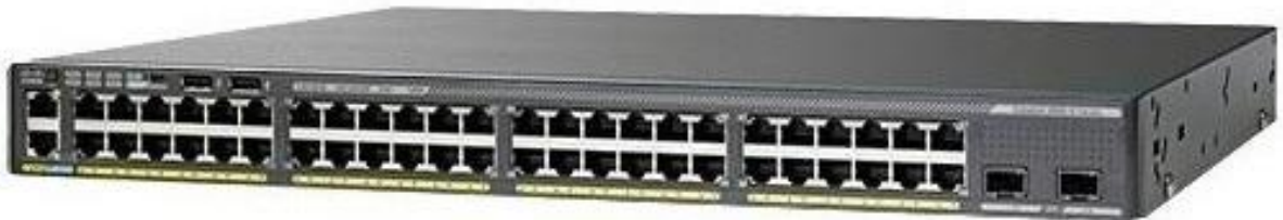
Рисунок 2.7 –Комутатор Cisco WS-C2960XR-48TD-I
