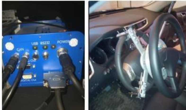
Рис. 3.6. Вимірювальний пристрій MSW/S Measurement Steering Wheel:
