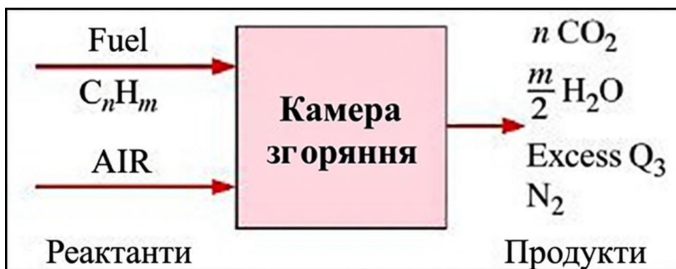
Рис. 1.8 - Ідеальне згоряння вуглеводневого палива в камері згоряння
