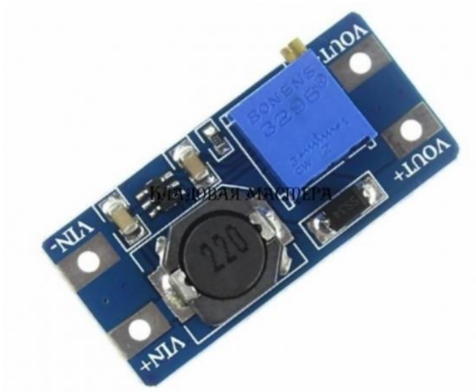
Рис. 3.4 Перетворювач напруги MT3608
