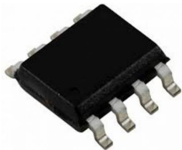
Рис. 3.5. Операційний підсилювач OPA177
