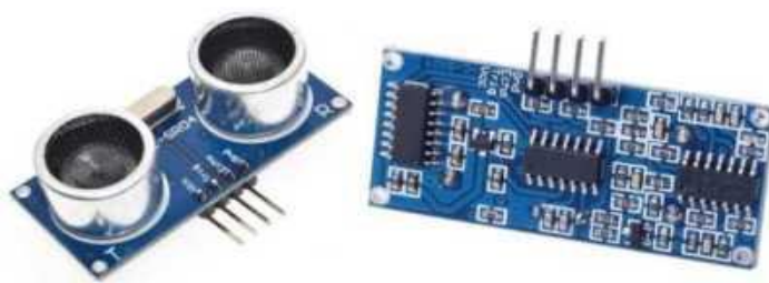
Рис. 2.3. Ультразвуковий далекомір HC-SR04
