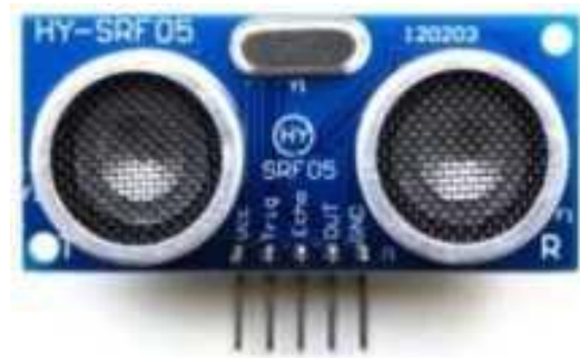
Рис. 2.9. Ультразвуковий далекомір HY-SRF05
