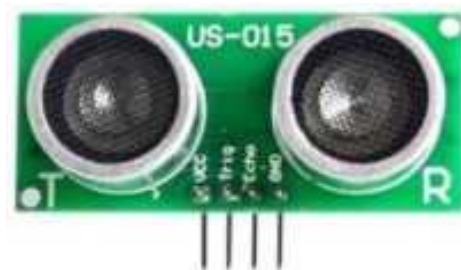
Рис. 2.10. Ультразвуковий далекомір US-015
