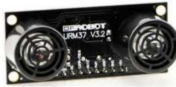
Рис. 2.11. Ультразвуковий далекомір URM37
