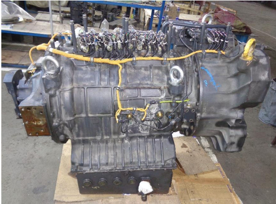
Рис. 3.2 - Автоматична коробка перемикання передач великовантажного самоскида Komatsu HD785-7 у зборі
