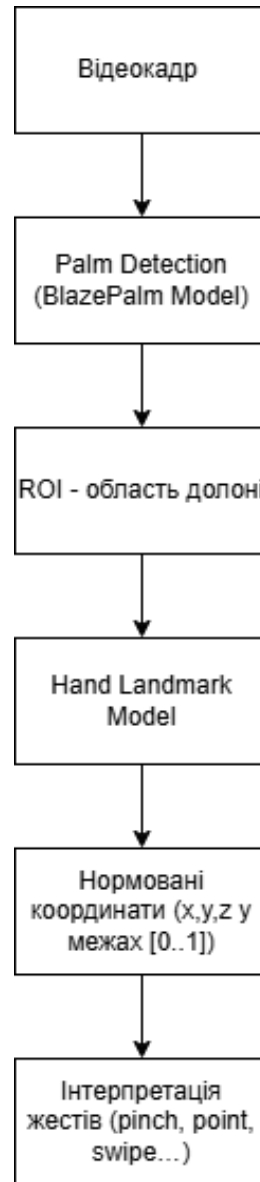
Рис. 2.3 - Блок-схема пайплайну MediaPipe Hands.
