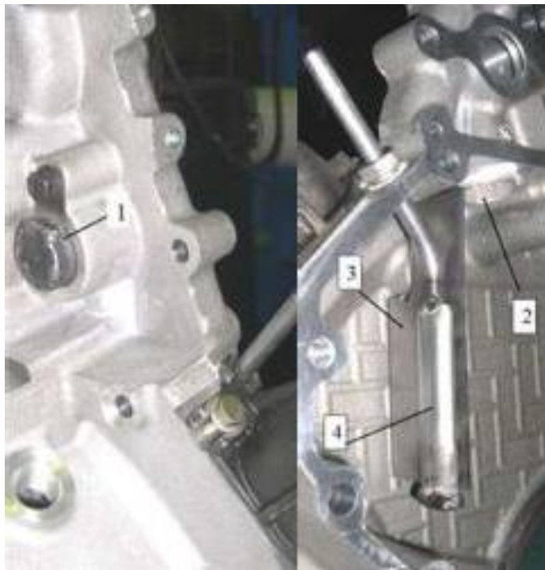
Рисунок 2.2 – Модифікація картера маховика: 1 - заглушка на місці стандартного оливовідділювача; 2 - отвір для газового зв'язку картерної вентиляції блоку циліндрів та картера маховика; 3 - екран, який запобігає прямому потраплянню масла в олійнозаливну горловину, обертову від шестерні приводу агрегатів; 4 - гідрозатвор з екраном
