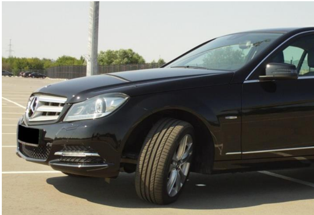
Рис 3.2 - Позитивний розвал внутрішнього колеса автомобіля Мерседес-Бенц при повороті, викликаний позитивним кутом нахилу осі повороту
